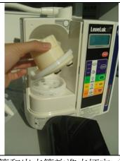
4. 把軟式導管和出水管放進水杯內,當水到大半杯時,關上水龍頭並放置 3~5 小時
